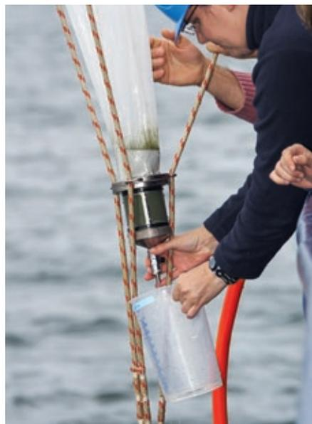
Mit dem Planktonnetz werden die Kleinstorganismen aus dem Wasser filtriert.
